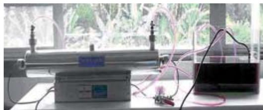
FIGURA 1. MONTAJE CON LÁMPARA UV REALIZADO PARA LA DEGRADACIÓN DE COLORANTES.
